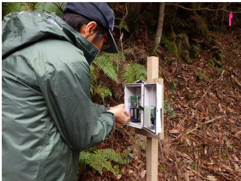
捕獲通知装置(みまわり楽太郎)の電池交換作業
