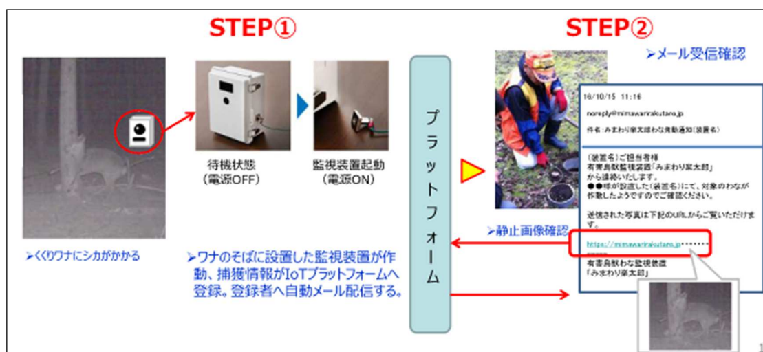
図 2.3.2 くくりワナに設置する監視装置と捕獲情報通知イメージ
