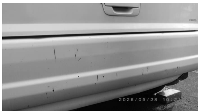
細かい傷が腐食している
