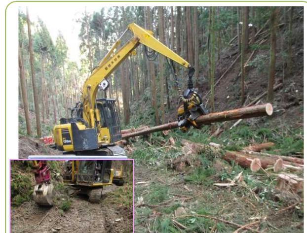
ハーベスタによる大径材の造材及びグラップルバケットによる路網作設
