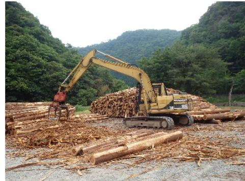
高性能林業機械による木材の仕分け作業
