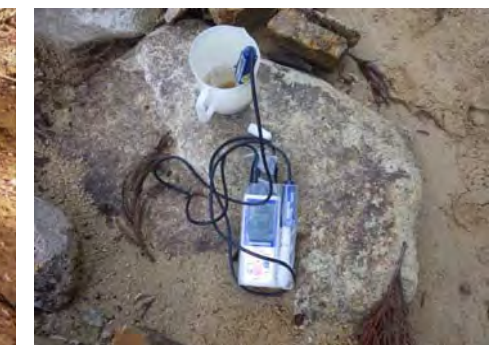
写真 6.1.3 土壌酸度の測定状況 ポータブル pH 計測器により、現地で土壌の pH を計測
