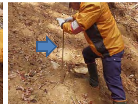
写真 6.1.2 土壌深の測定状況 検土杖を、地中に貫入させて基岩にあたる深度を計測
