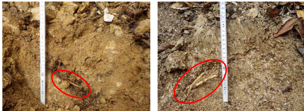
写真 6.1.4 カタクレーサイト化した花崗岩内にも伸長した樹木の根系
