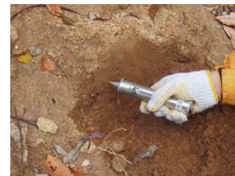
写真 6.1.1 土壌硬度の測定状況 山中式土壌硬度計を土壌に押し込み、抵抗値を測定
