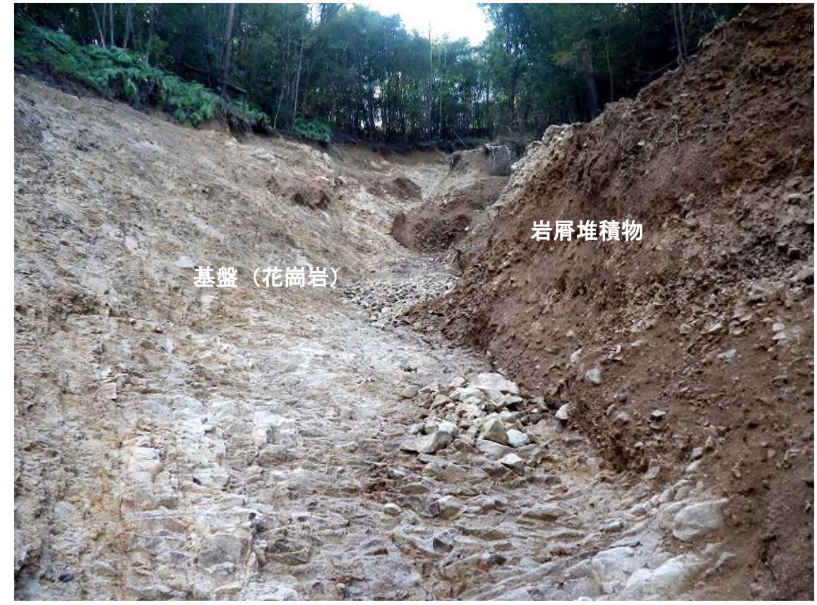
写真 3.1.4-D 高松山 3 号地(ホ-1-3) 右岸側には花崗岩が、左岸側には岩屑堆積物が分布
