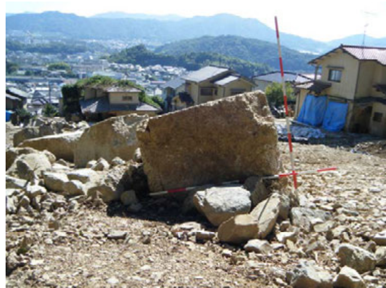
写真① 流失コンクリート片 (1.2m×4.8m×1.4m) (写真撮影日 2014年10月8日)
