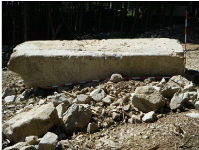
写真② 流失コンクリート片 (1.0m×4.8m×1.2m) (写真撮影日 2014年10月8日)
