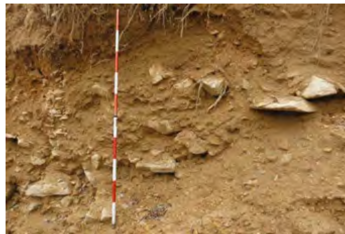
②岩屑堆積物 角礫と締まった砂よりなる未固結堆積物 滑落崖上ではパイプが分布する箇所あり
