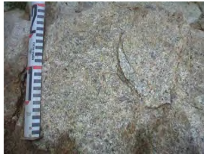
④中粒黒雲母花崗岩 高松山では最も広く分布する 節理が発達したものが多く
