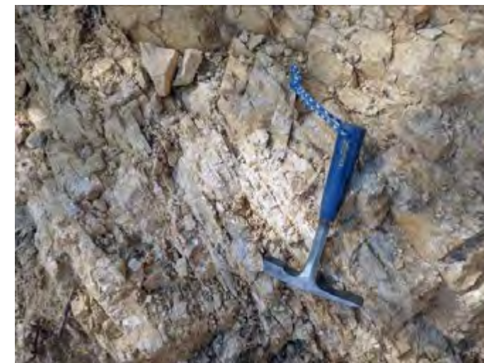
⑧テクトニックな節理の発達した花崗岩 方向性が明瞭な節理を有する
