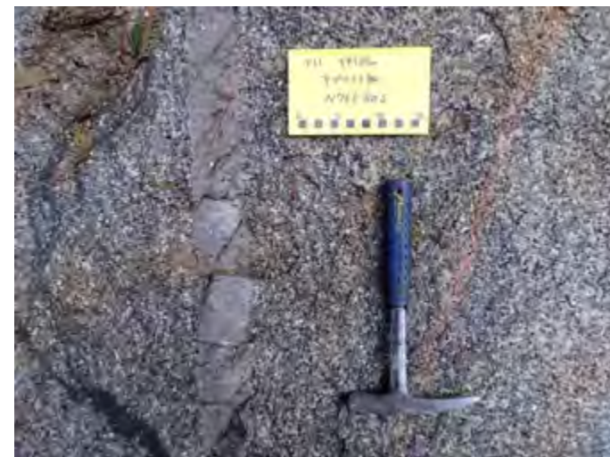
⑤粗粒黒雲母花崗岩 ④に比べると節理が少なく、風化の抵抗力が弱い 中央左付近の白色脈はアプライト
