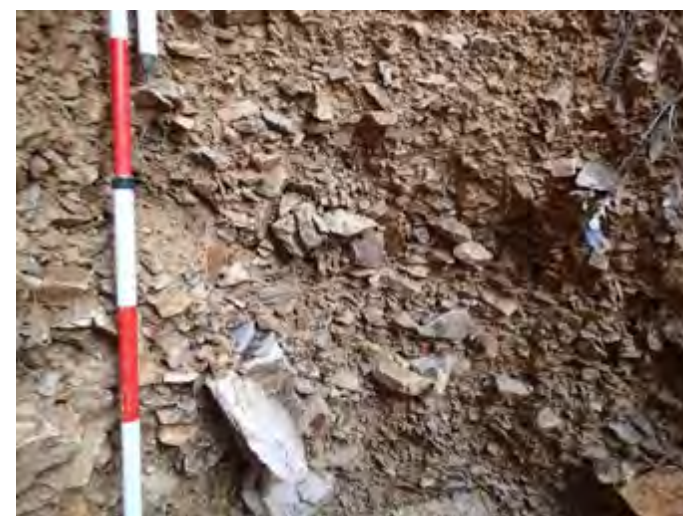
③岩屑堆積物 角礫を主体とした未固結堆積物 谷底に厚く分布すること多い
