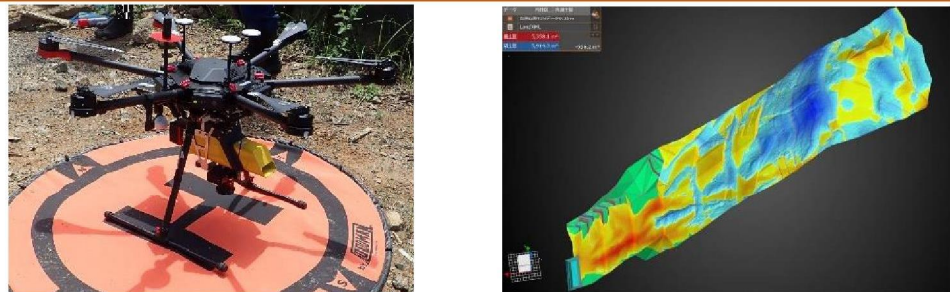
▲測量に使用した UAVレーザー測量機器
