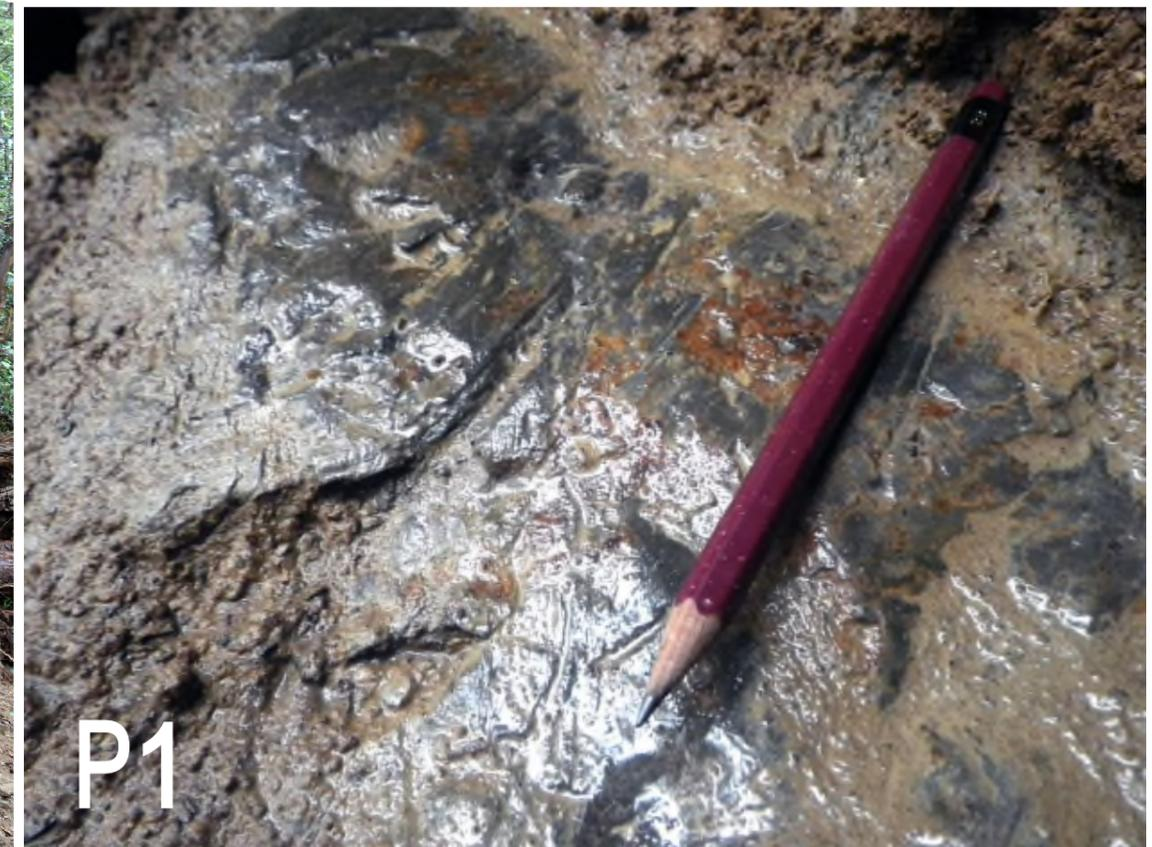
すべり面は鏡肌を呈し条線(鉛筆の方向)がみられる 条線は N80E(10)
