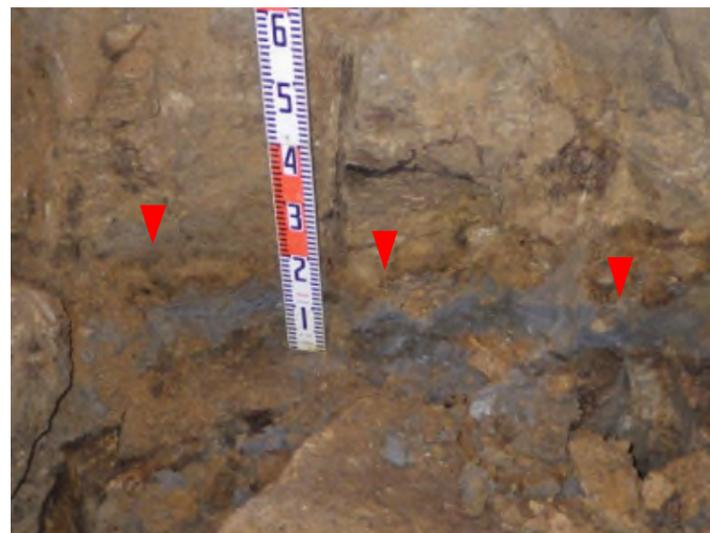
3号集水井 LS2 下端の破砕粘土(深度 38~39m)
