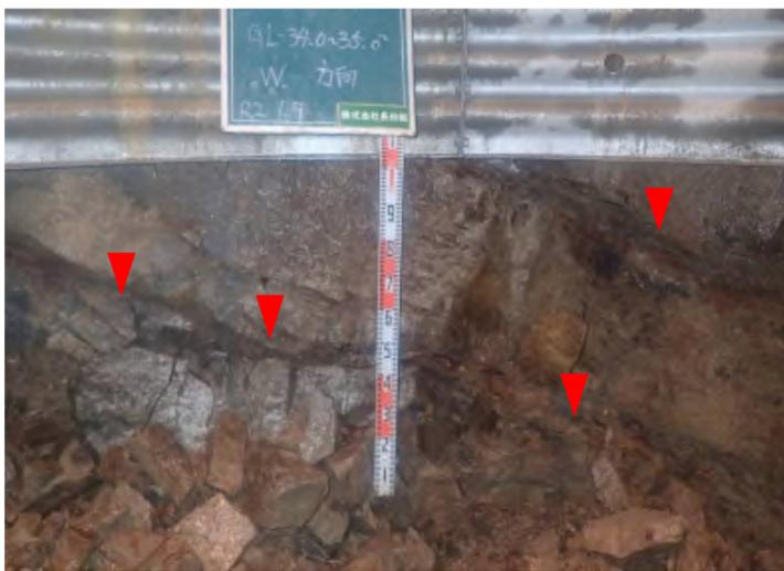
2号集水井 LS2 移動土塊の破砕箇所(34~35m)
