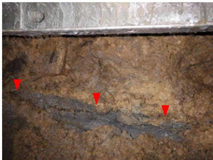
3号集水井 LS2 下端推定すべり面の破砕粘土(深度 38~39m)
