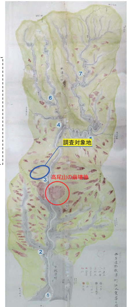
図 2.2 西牟婁郡秋津三ヶ村洪水災害之絵図 (榎本全部作; 上会津愛郷会蔵) → 絵地図師・榎本全部が描いた右会津川 (秋津川) 流域の土砂災害・洪水氾濫分布図。 ①旧田辺市街地 ②左向谷 (デレーク堰堤と呼ばれる巨石積堰堤などが存在する溪流) ③高尾山の大规模崩壊地 (深層崩壊) 右会津川の左岸側、右岸側にも少し規模の小さな崩壊地が認められる。
