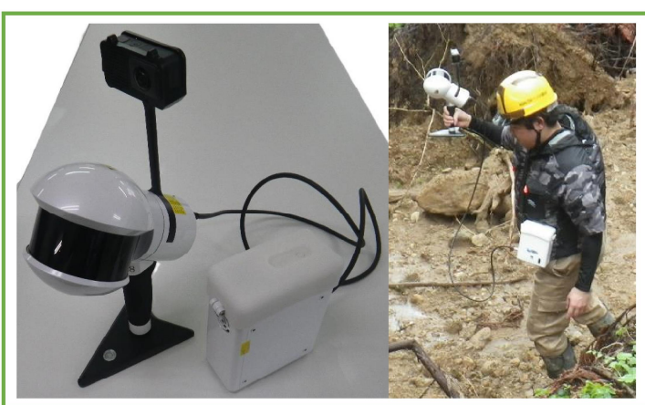
使用した手持ちLiDAR機器（LiDAR SLAM）と作業風景
