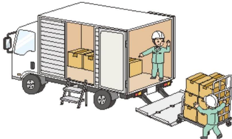
労働安全衛生規則(以下「安衛則」といいます)が改正され「昇降設備の設置」「保護帽の着用」「テールゲートリフターの操作に係る特別教育」が義務付けられました。
