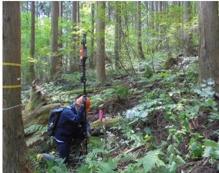
地上型3Dレーザスキャナによる 収穫調査
