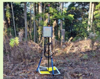
高精度GNSS受信機(RTK3周波)の活用
