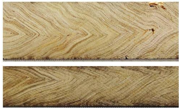
図5 褶曲配向ボードの断面： 上 圧縮率 51% 下 圧縮率 66%
