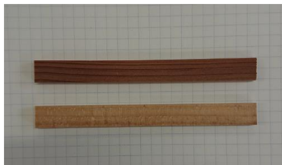
図1 弾性試験に用いる木材試験体 スギ(上) ブナ(下)
