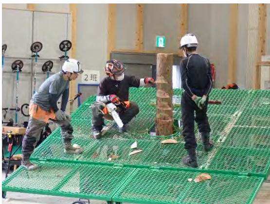
屋内で繰り返し伐倒練習が可能な伐倒練習機
