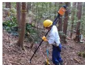
【3次元地上レーザスキャナの使用状況】
