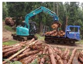
【中間土場での積卸作業】
