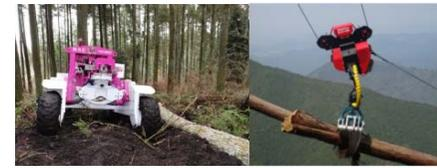
● 自動伐倒作業車 ● 自動集材機
