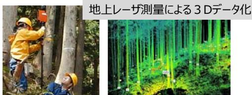
地上レーザ測量による3Dデータ化
