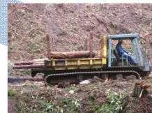
林内作業車により集材（土場へ）
