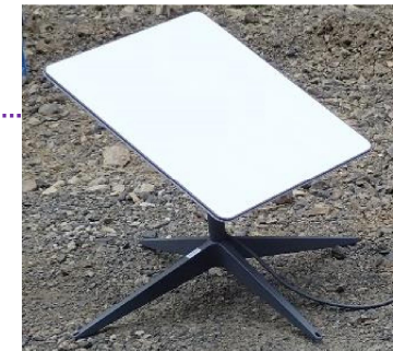
衛星通信アンテナ
