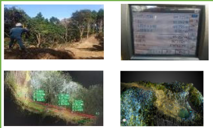
起工前測量で地上型レーザースキャンを活用し3次元データを作成。
