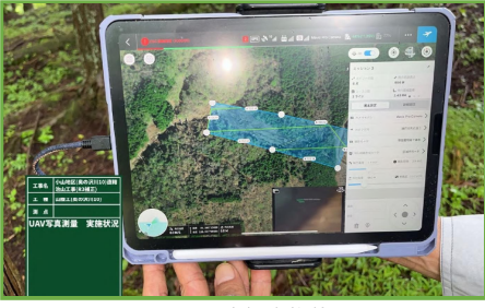
ドローン空撮実施状況
