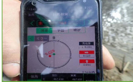
床掘確認(座標で確認)
