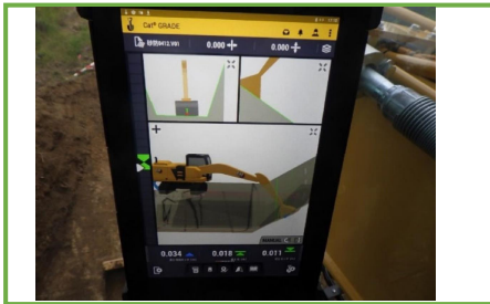
MGバックホウの操作画面
