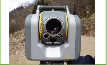
山腹面全体の測量する3Dレーザースキャナー (ニコン: Trimble X10)
