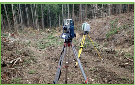
レーザースキャナを用いた起工測量
