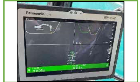
タブレット画面（高さ・幅ガイダンス）
