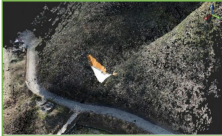
UAVによるレーザ起工測量
