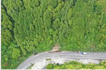
UAVを利用による着工前及び完了写真の撮影、3Dモデル作成による着工前測量の実施。
