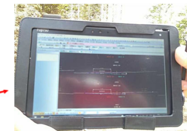
現地での出来形確認の際にタブレットPCでCADを活用し、画面上で設計図上の距離や面積の確認を行い、設計変更にも素早く対応
