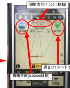
自動追尾型測量機器を活用し、測定位置の幅、高さなどをリアルタイムで確認
