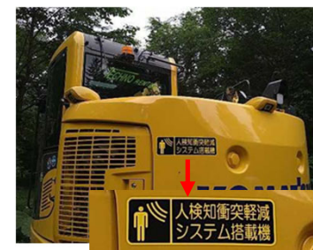
バックホウに360度カメラや人検知衝突軽減システムを装備し事故を防止
