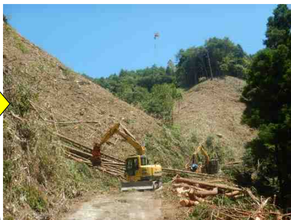
高性能林業機械を使った採材作業
