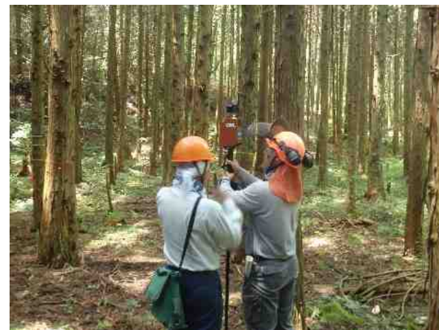
3次元レーザスキャナの使用状況
