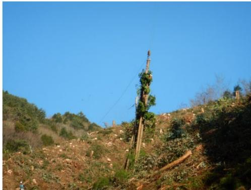
架線集材による搬出
