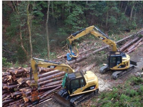
高性能林業機械を使った採材作業
