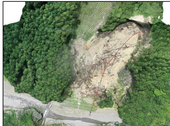
【オルソ画像を基に平面図、縦断測量図等を作成】
