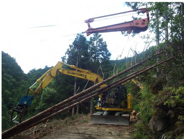
架線集材される間伐木 （大又国有林 熊野市）
