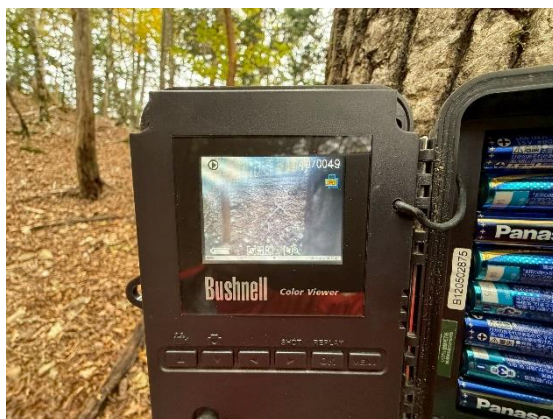
S05：動作不良 現地で撮影状況を確認、設定を更新後起動しなかった。
