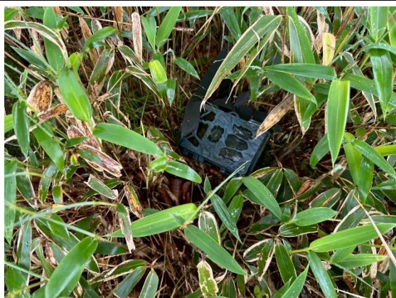
15-2：破損状況 バンドが切れカメラが脱落していた。
