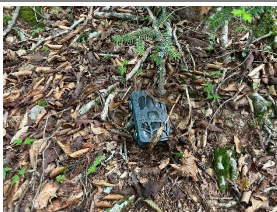
R2-4：破損状況 バンドが切れカメラが脱落していた。
