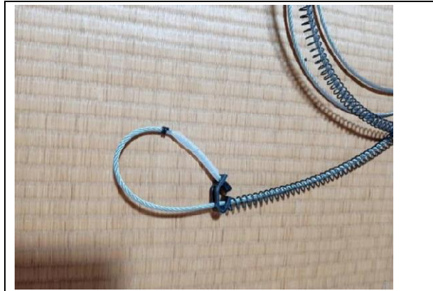
写真8 シリコンチューブで保護したワイヤー
