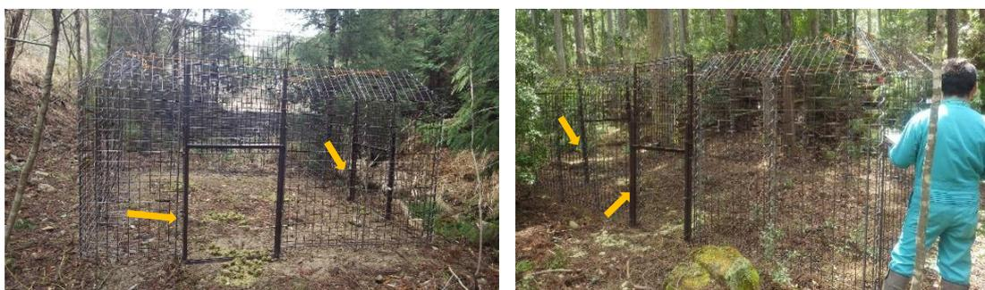
写真3. 大師谷国有林（左）及び日笠山国有林（右）に設置した囲いわな扉は2箇所ずつ設置した（黄色矢印）。大師谷の囲いわなは写真手前側面と右手側面に扉を設置、日笠山の囲いわなは写真左手側面とその奥側面に扉を設置した
