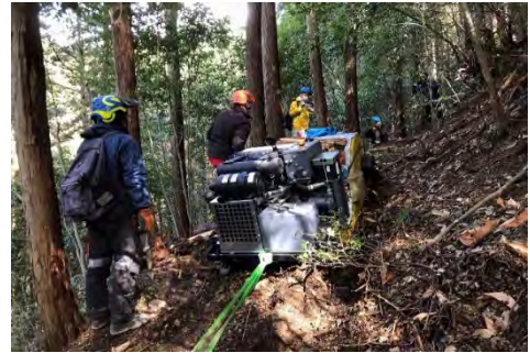
自走するスイス式油圧集材機
