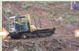
【林内作業車による運搬】
