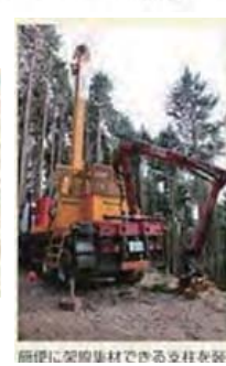
編組に架橋集材できる支柱を装 タワーヤード.jpg
