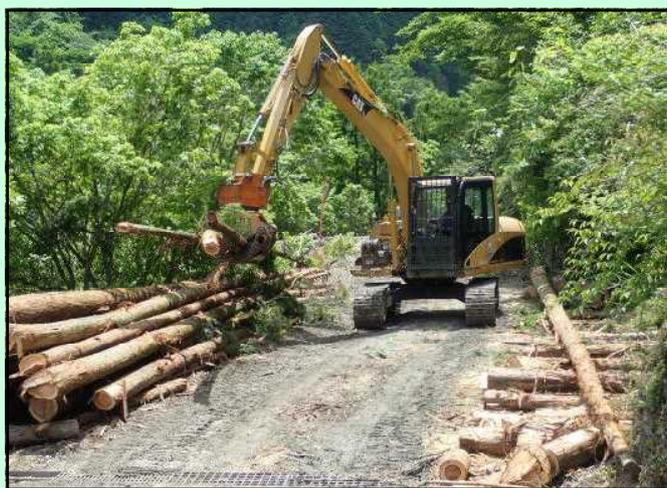
写真4 グラップルで作業箇所まで運搬します
