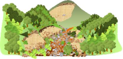
渓岸部の崩壊により山腹斜面が一層不安定になり、崩壊の拡大や、山裾の崩壊が進行し、大量の土砂が流出。
