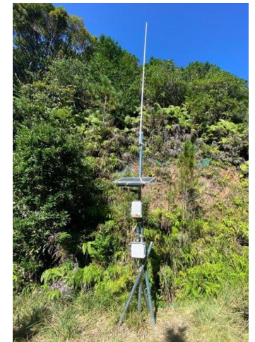
親機の設置状況
