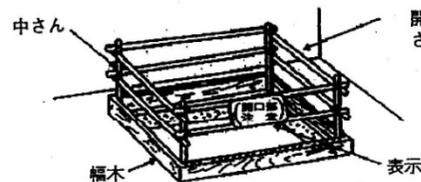
開口部、作業床の端には、高さ90cm以上の手すりを設ける。
