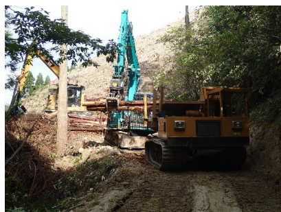
丸太加工（ハーベスタ）・丸太の積み込み（グラップル）・運搬車（フォワーダ）の連携で運材効率アップ
