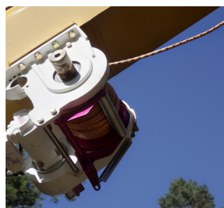
強度・操作性に優れた繊維ロープの使用で、伐倒木へのロープ掛け（玉掛け）作業の効率アップ
