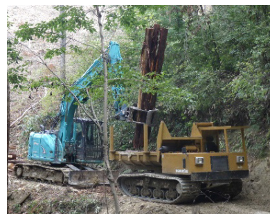
良材・低質材ごとに運搬車（フォワーダ）に積み込むことで土場での仕分けを省力化
