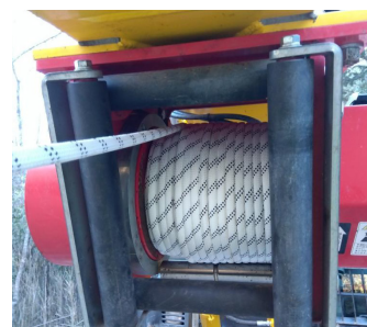
強度・操作性に優れた繊維ロープの使用で、伐倒木へのロープ掛け（玉掛け）作業の効率アップ
