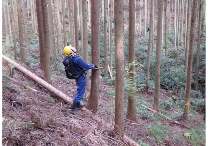
【輪尺による直径計測】
