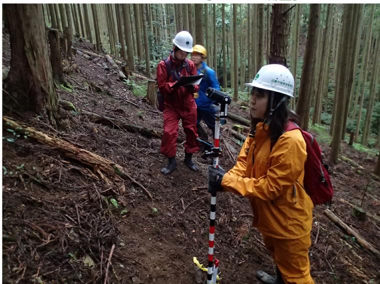
【レーザー測距器による区域測量】
