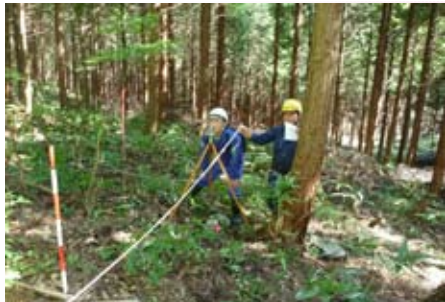
コンパス（測量器具）を使って境界の不明箇所を探し出す実習をしている様子
