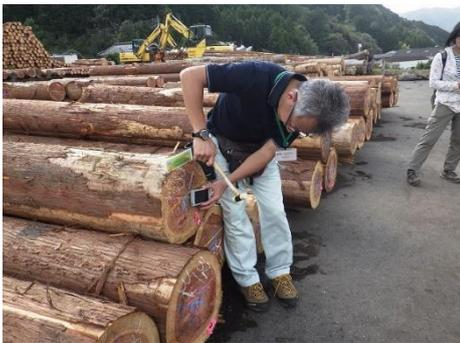
写真－2 固有振動数測定状況
