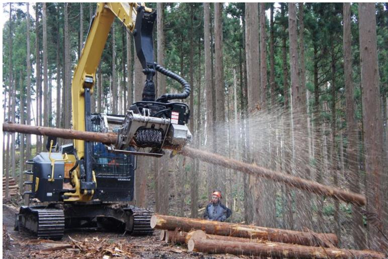
図-8 プロセッサによる造材作業
