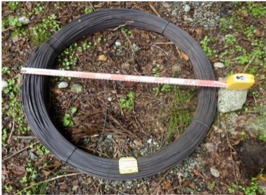
写真-3 鉄線重量 25kg/巻
