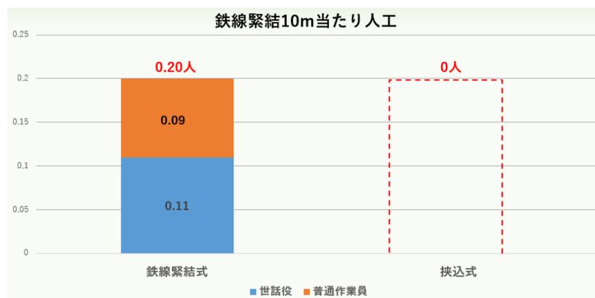
図-6 鉄線緊結 10m 当たり人工
