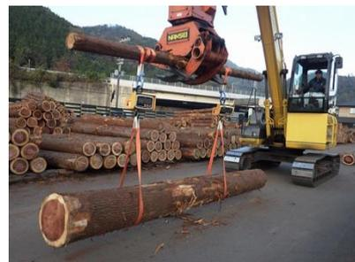
写真-1 重機による重量測定
