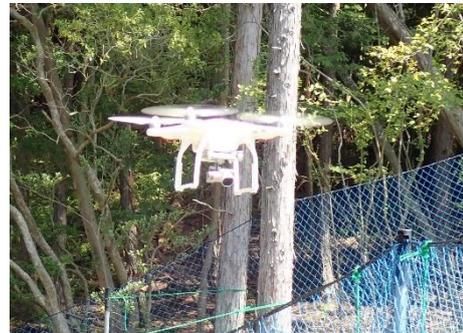
写真－1 ドローンによる防護柵点検
