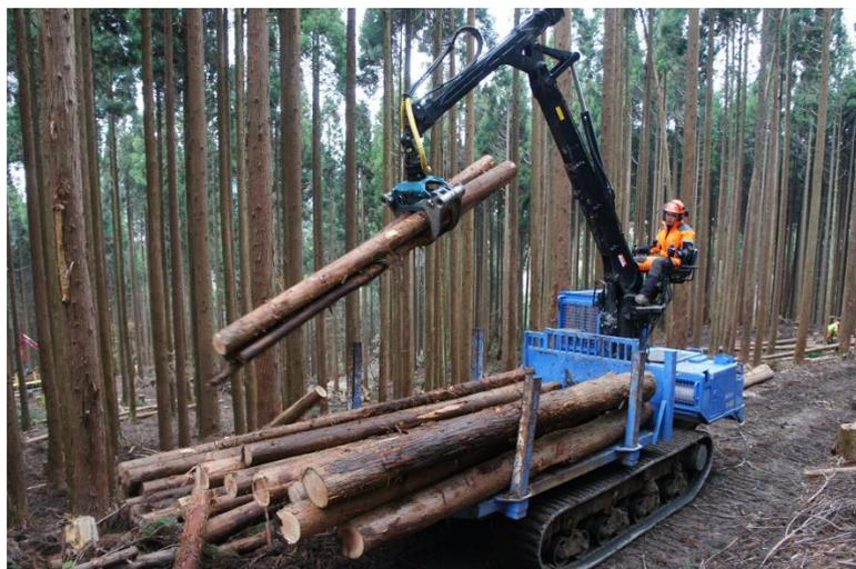
図-9 フォワーダによる運搬作業
