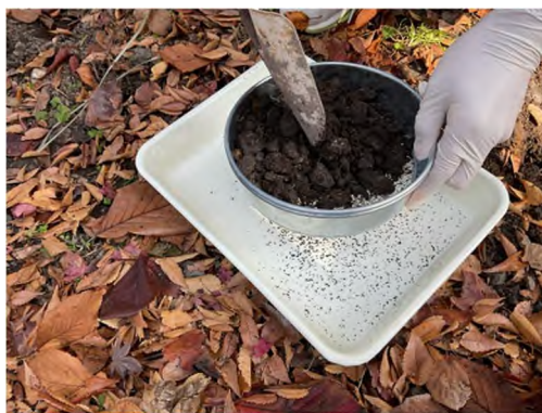
図1 篩と移植ごてを用いた土壌前処理の様子
