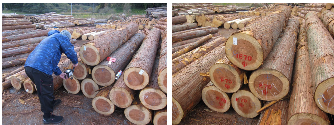
写真－3 木材市場でのスギ特 A 材供給の取り組み 左：簡易検査器による丸太のヤング係数の測定 右：スギ特 A 材の表示をして競りにかけられる丸太
