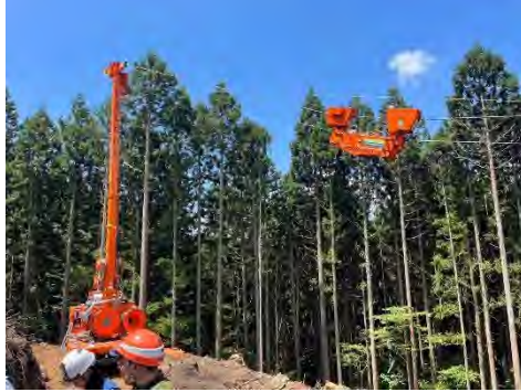
写真—1 タワーヤーダによる全木集材
