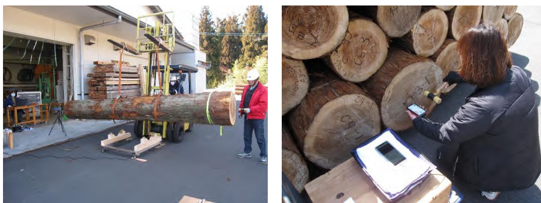
写真-1 スギ丸太のヤング係数測定
