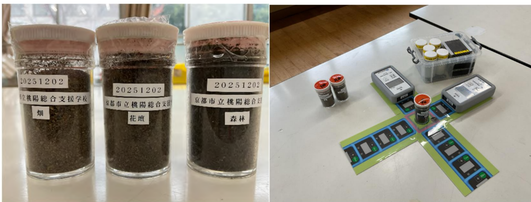
図3 学校林で採集した土壌等を用いた自然放射線の測定 （左：サンプル瓶簡易封入後の土壌，右：自然放射線測定の実施の様子）
