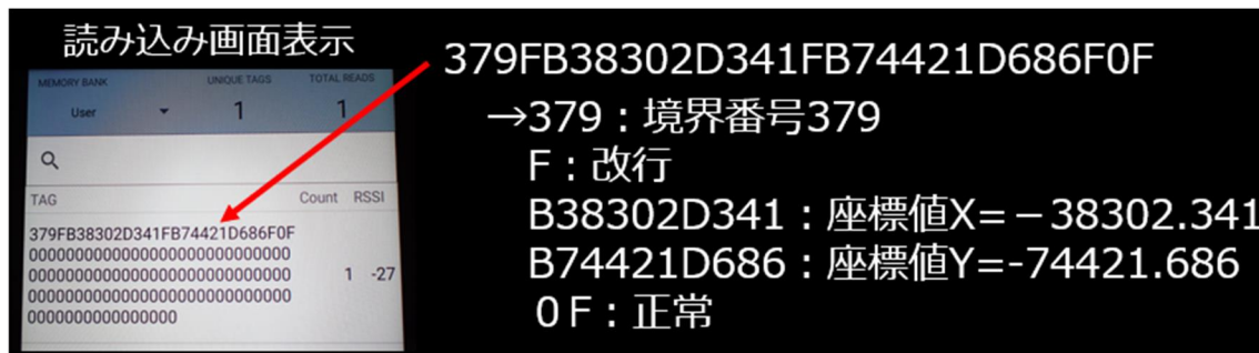
図-4 ハンディリーダーによる境界標情報の読み込み結果
