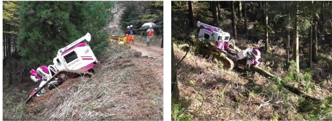
図 3 ラジコン式伐倒作業車の作業状況
