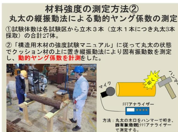
図－5 原木丸太の縦振動法による動的ヤング係数の測定
