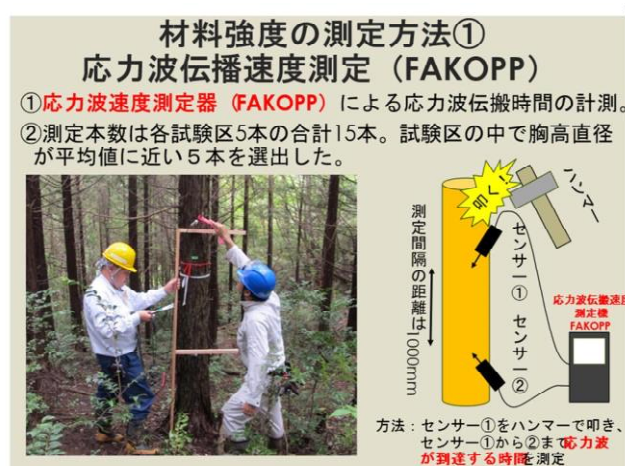
図－4 立木の応力波伝播速度測定（FAKOPP）
