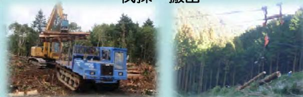
木材を搬出後、フォワーダ・集材機等により防護柵資材・コンテナ苗等の造林資材を運搬
