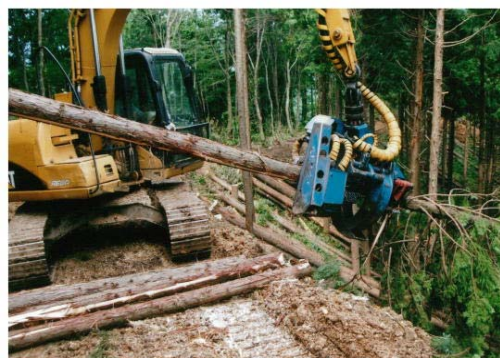
(高性能林業機械による造材の様子)
