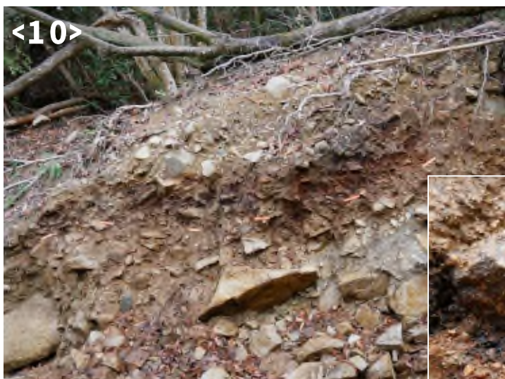
写真 13-11 堆積物中の水みちを示す礫表面の水酸化鉄
