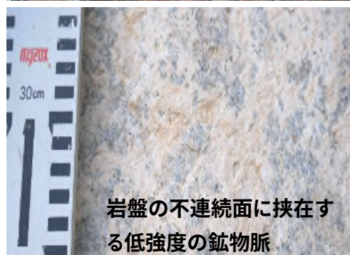
図 28 巨石形成および水理構造形成に係わる地質因子
