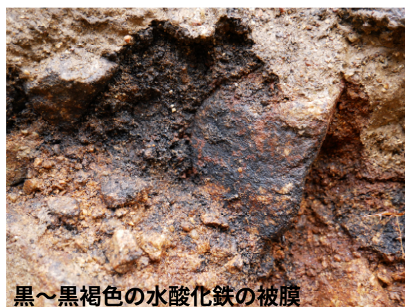
図 30 地下水因子をなす浅層地下水の水みちの痕跡を示す水酸化鉄による礫の被膜
