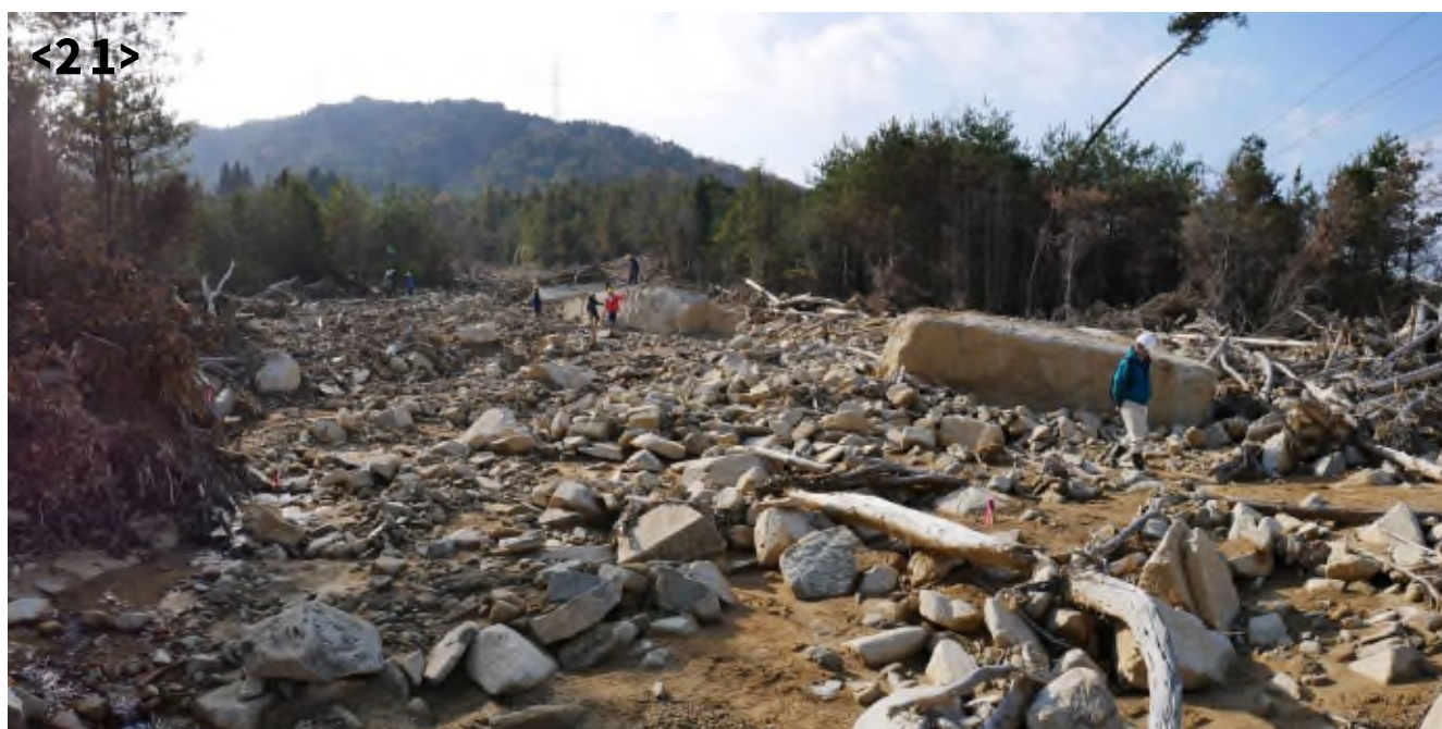
写真 17-14 ③溪流の堆積区の堰堤の破片、巨石・巨礫を含んだ土石流堆積物
