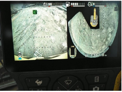
バックカメラ付き重機を使用した安全対策
